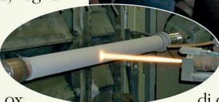
Con i giusti accorgimenti permette inoltre di depositare a velocità supersoniche (quindi superiori a 1 Mach) i compositi a matrice metallica.
